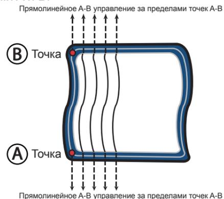
**Прямолинейный режим A-B** обеспечивает прямое управление между двух точек координат A / B.
